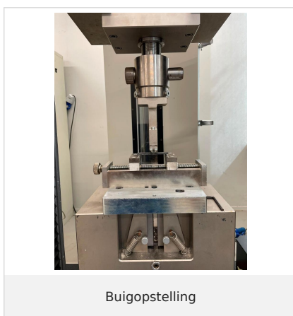
Figuur 2 - Opstelling trekproef. | Figuur 3 - Opstelling buigproef. | Figuur 4 - Opstelling drukproef.
