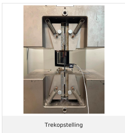
Figuur 2 - Opstelling trekproef. | Figuur 3 - Opstelling buigproef. | Figuur 4 - Opstelling drukproef.
